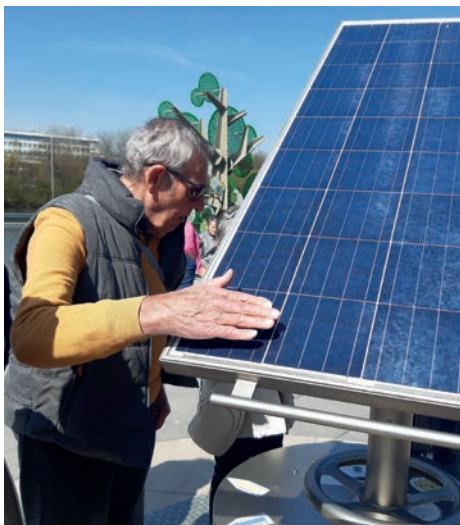
Auch eine Handfläche verursacht bereits so viel Schatten, dass sich der Ertrag des Solarmoduls erkennbar verringert.
