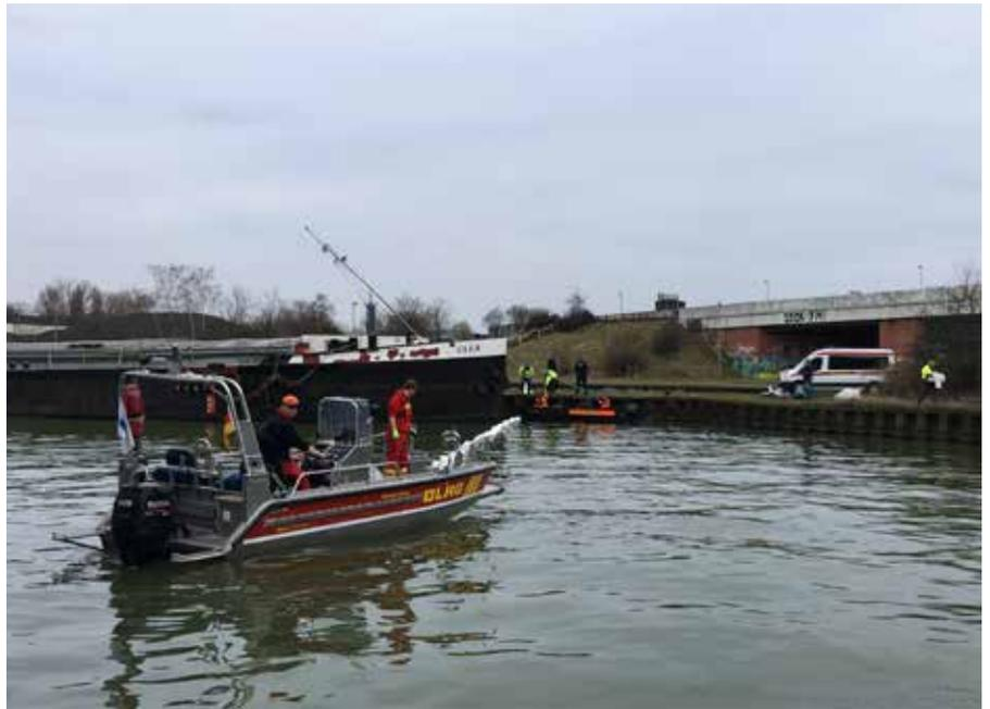
Einsatzkräfte der DLRG Münster setzen auf dem Kanal Ölsperren, um eine Ausbreitung der umweltschädlichen Substanzen zu verhindern. Foto: sg
