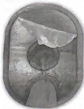
Abbildung 2: Abgelöstes, übereinander gefaltetes Gel kann auch verfärbt und/oder geschmolzen aussehen.
