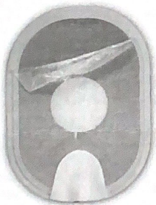
Abbildung 1: Abgelöstes Gel, das sich beim Abziehen übereinander gefaltet hat.
